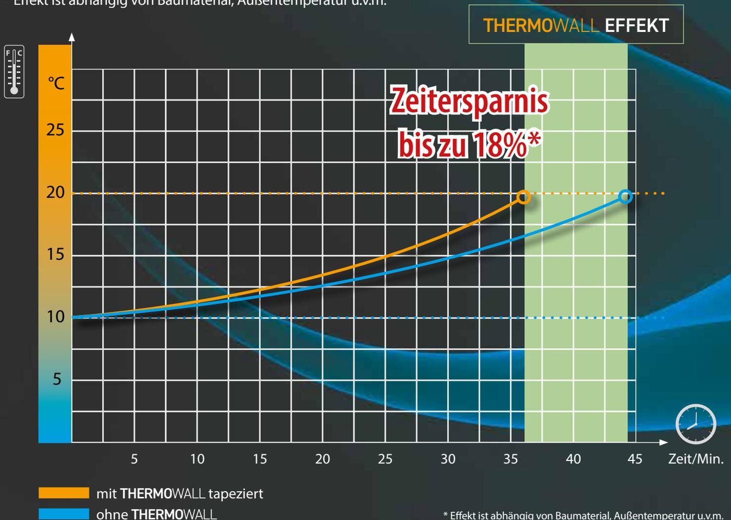
\* die ermittelten Werte basieren auf einer Testanordnung für einen einfachen Wohnraum: 3 Innenwänden, Rigipsaufbau in Trockenbauweise, 1 Tür-/Fensterelement, 1 Außenwand mit Vorsatz-Rigipswand im Innenbereich. Grundfläche des Raumes: 11,75 qm, Deckenhöhe 2,85 m.
